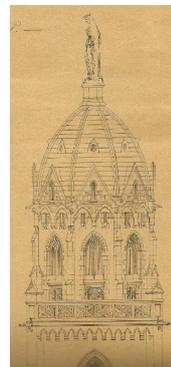
Pour la reconstruction du clocher, un projet propose de réaliser un dôme, surmonté d'une statue en plomb. Il sera abandonné pour cause de budget. Le clocher est reconstruit en matériaux de très bonne qualité : chaux des fours de Pornic, sable de Loire ou de dune pour les mortiers, pierre de St Savinien pour l'extérieur et tuf pour l'intérieur, brique, bois et fer pour le reste.
