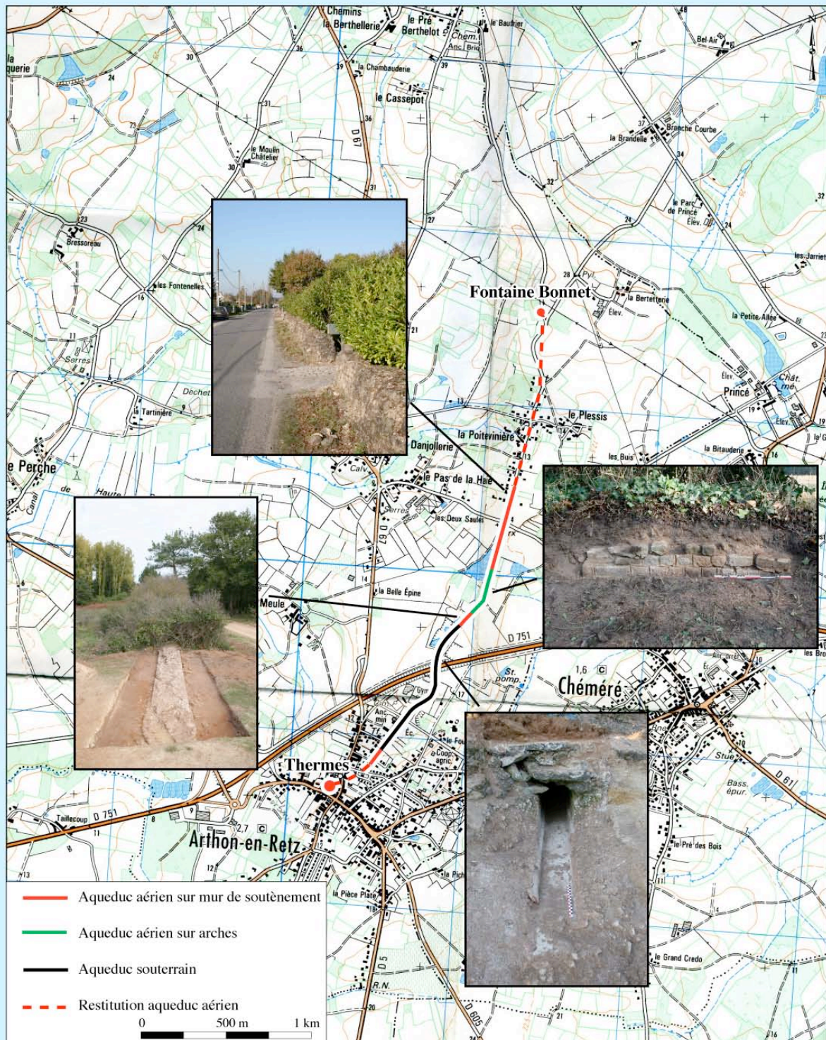
Arthon-en-Retz (44). Le parcours de l'aqueduc gallo-romain sur fond de carte topographique IGN
